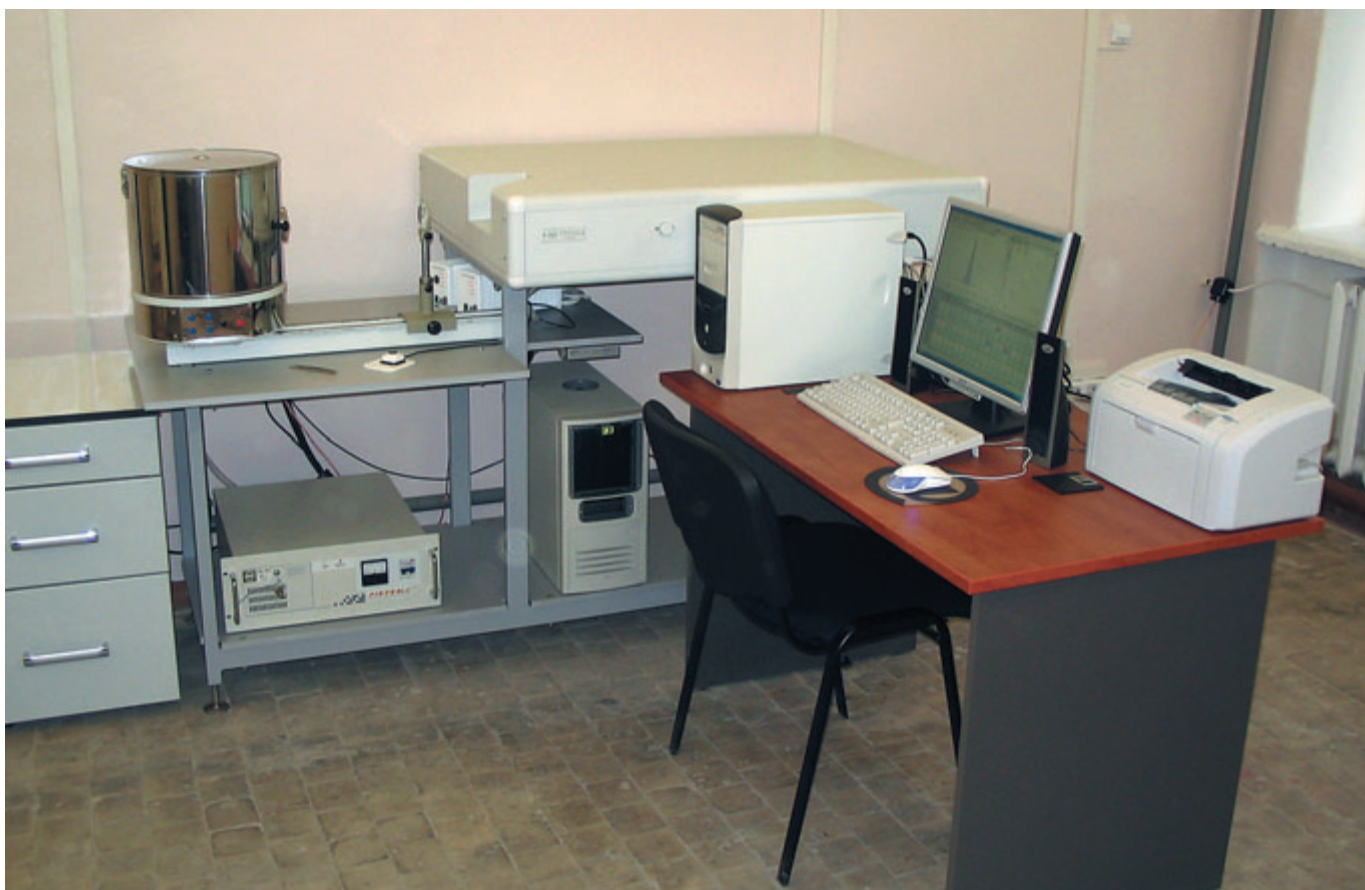
Спектроаналитический комплекс «Гранд» с универсальным штативом для анализа материалов с дуговым и искровым возбуждением спектров
