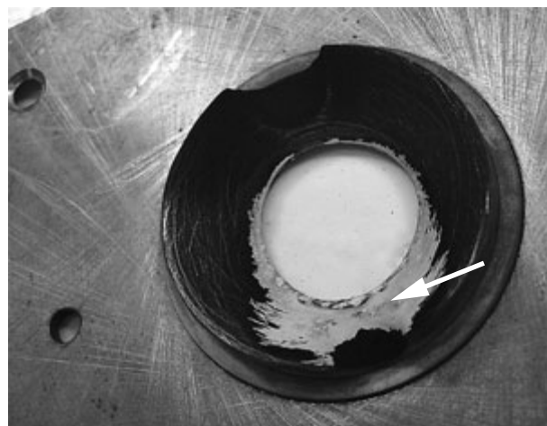
Рис. 1. Следы разряда на внутренней поверхности столика штатива
