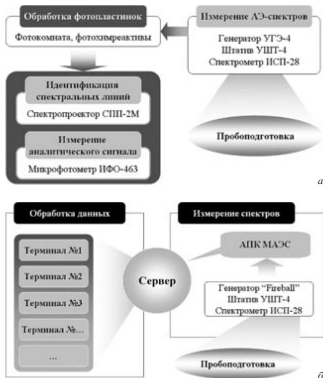
Рис. 2. Схема выполнения практических задач по атомно-эмиссионной спектроскопии при использовании фотографической (а) и фотоэлектрической (б) регистрации аналитического сигнала
