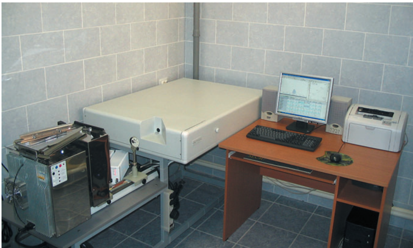
Спектроаналитический комплекс «Гранд» для анализа порошковых проб по методу «просыпки-вдувания» в дуговой разряд
